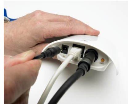
Koppla in nätadaptern i X1-märkta anslutningskontakten.
