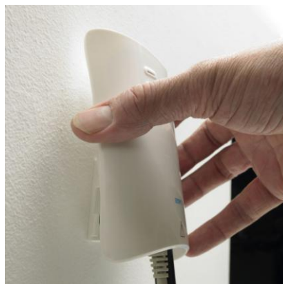
Sätt fast kontrollenheten på väggmonteringen genom att låta den glida ned över monteringen.
