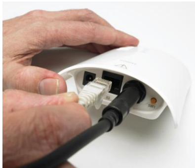
Om relä-utgången ska kopplas till ett annat system, sätt i passande kopplingsledning i anslutningskontakt X2.
